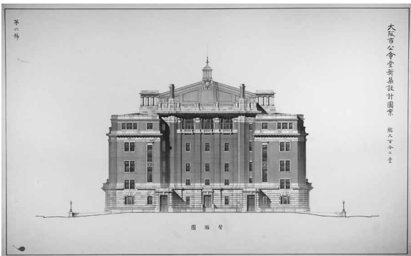
0907 田邊淳吉案 大阪市公会堂新築設計図案 第六号 背面図 縮尺百分之一
